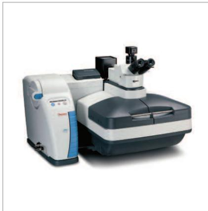
비접촉 방식으로 수  $\mu m$  크기의 국소부위의 화학 구조변화를 측정하는 기기로 도막 및 나노 소재의 화학적 특성 분석
