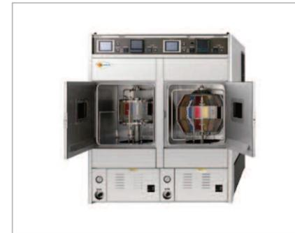
태양광을 모사하기 위해 Xenon, Metalizing Lamp로 재료 및 도막의 내구성, 내후성 평가
